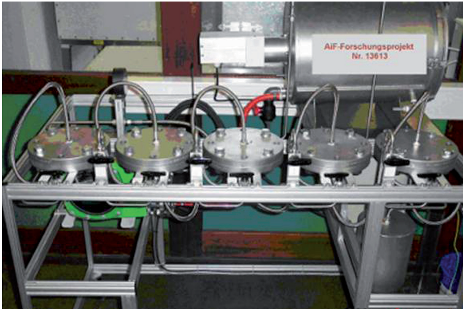
Abbildung 1: Funktionsmuster zur Schnellextraktion von Textilien; AIF-Forschungsvorhaben des wfk-Forschungsinstituts
